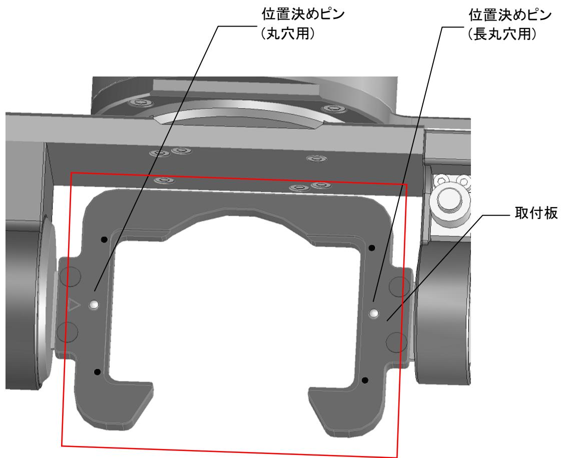
③嵌め合わせた後で、ブロック固定プレートを4本の六角ボルトで固定してください。六角ボルトの固定は付属のトルクドライバー(0.3N·m)とビット(幅3.0mm)を使用し、(1)～(4)のように対角順で4本の六角ボルトで固定してください。対角順であれば、締める順番は任意です。
