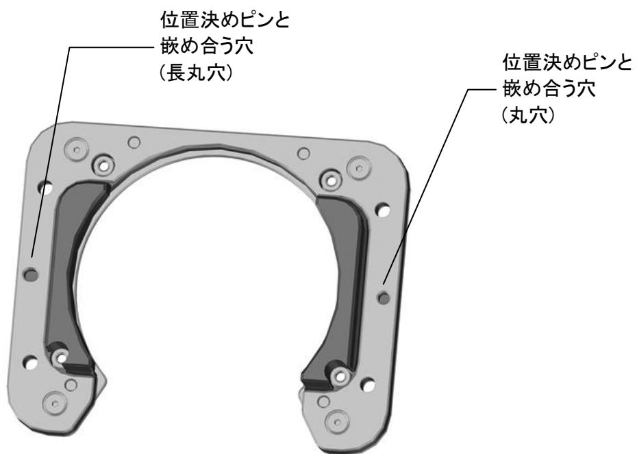
ディスク固定プレートを  $180^{\circ}$  反転した図
