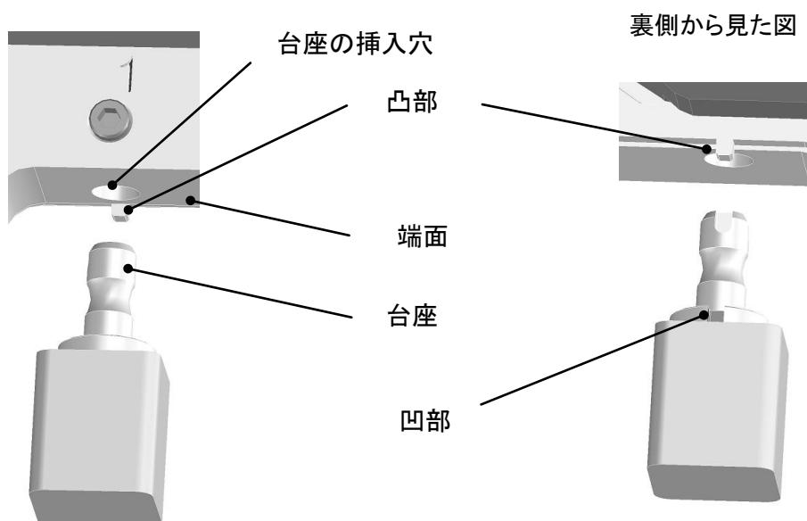
③付属のトルクグリップ(1.4N・m)を使用して、止めねじでブロックの台座を固定します。
