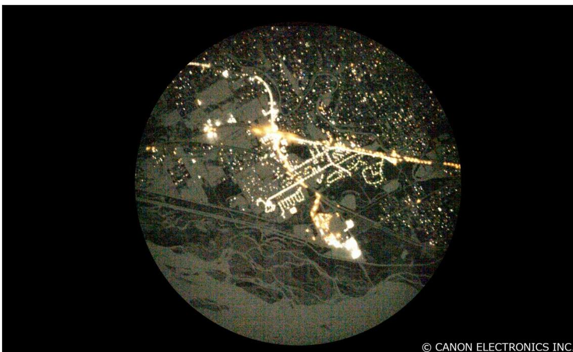
CE-SAT-IIBは、口径200mmの望遠鏡に新規の自社開発品である超高感度カメラを組み合わせた撮像装置を搭載しており、夜間、月明り程度のわずかな光源によって照らされた地上の観測が可能な仕様となっています。この性能を実証するために、望遠鏡のピント合わせ・夜間における地表点指向姿勢の確立など、所定の準備を実施した後に、超高感度カメラを用いて人工照明の少ない地表面の撮影試験に挑みました。
