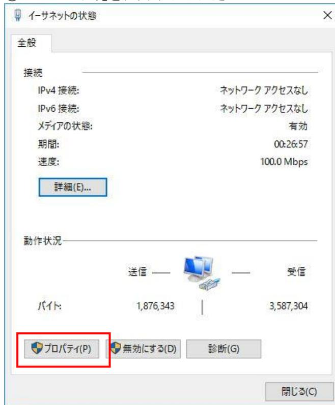
⑤ インターネットプロトコルバージョン4(TCP/IPv4)を選択して「プロパティ」をクリックしてください。
